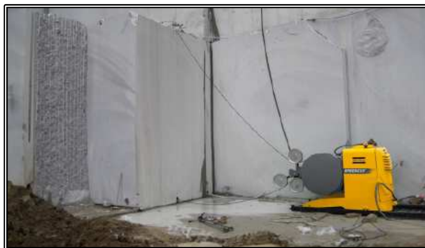
Figura 12: Máquina de corte com fio diamantado. Observar a superfície de corte bem acabada.
