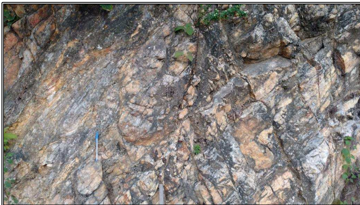
Figura 8: Vista parcial do maciço rochoso do terreno, com destaque ao grau de fraturamento da rocha.
