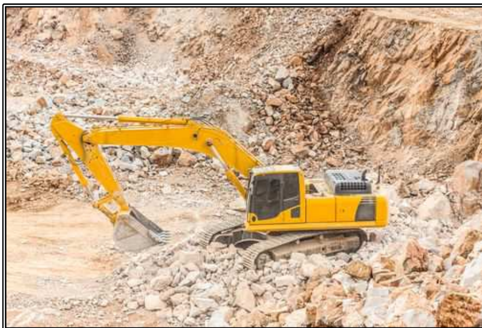
Figura 11: Escavadeira hidráulica sobre a pilha de rocha desmontada preparando o carregamento do material sobre os caminhões rodoviários.
